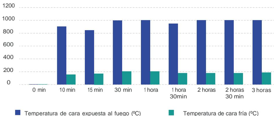
Figura 1. Temperaturas en la superficie de una tabla roca, cara expuesta al fuego y cara posterior. En la cara posterior, la temperatura no llega a 250°C a pesar de llegar a 1000°C en la cara expuesta.
